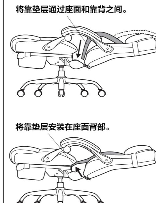
将靠垫层安装在座面背部。
