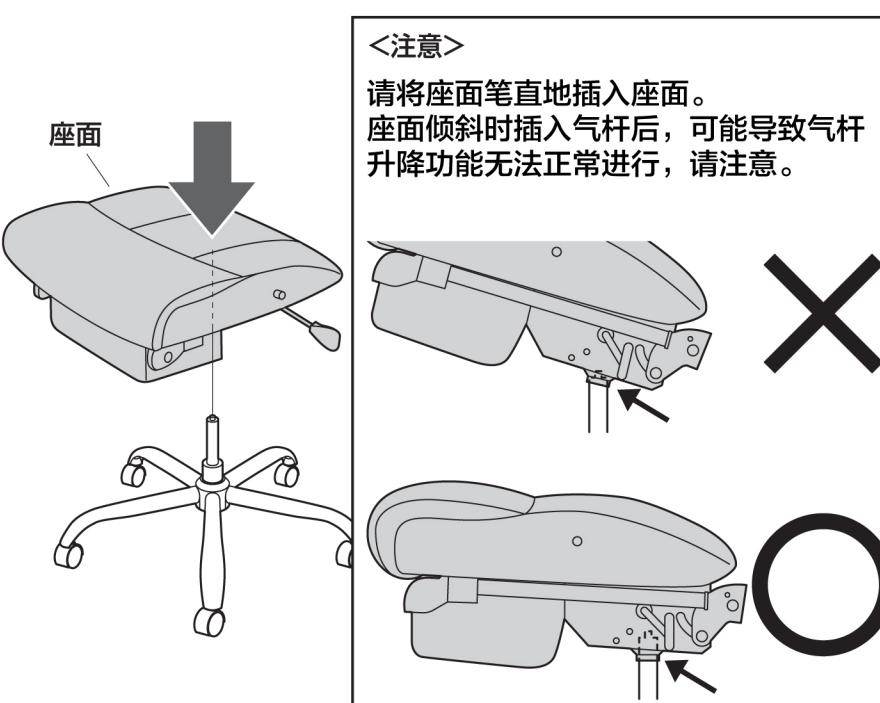
\*为了将座面完全插入气杆，请利用体重将其完全压入气杆内。
