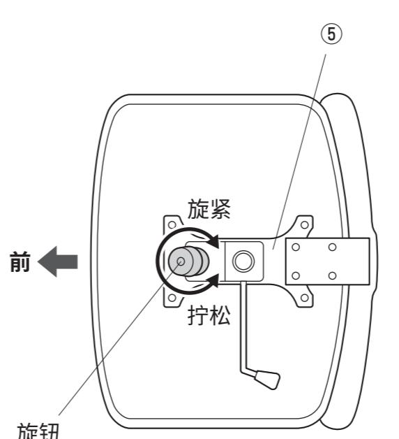
从下方看，顺时针旋转旋钮可使锁定更紧，逆时针旋转旋钮可使锁定更松。
