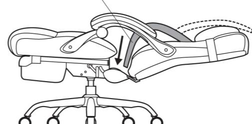
将靠垫层安装在座面背部。
