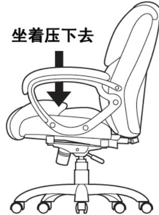
※如果气杆没有插入到底，座椅调节高度的功能将无法使用。
